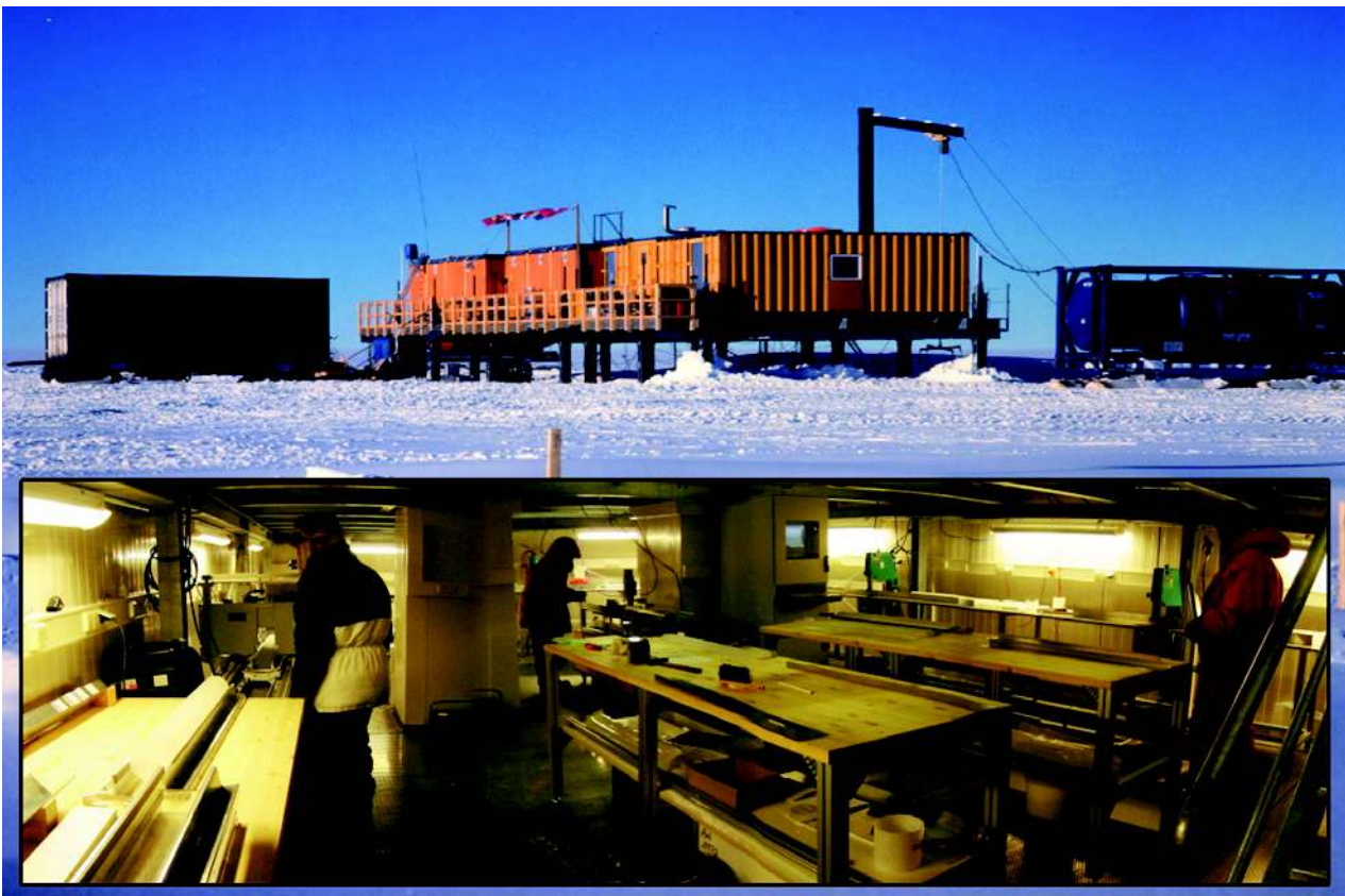
Abb. 1. oben: Bohren eines tiefen Eiskerns im Dronning Maud Land im Rahmen des EPICA Projektes unten: Eislabor zur Präparation von Eiskernen im Alfred Wegener Institut, Bremerhaven
